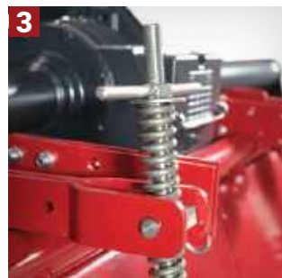
HINTERE ABDECKUNG Grad der Bodenzerkleinerung durch die Einstellung der Position einstellbar
