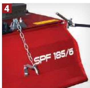
HINTERE ABDECKUNG Durch die Einstellung der Position wird der Grad der Bodenzerkleinerung ein- gestellt
