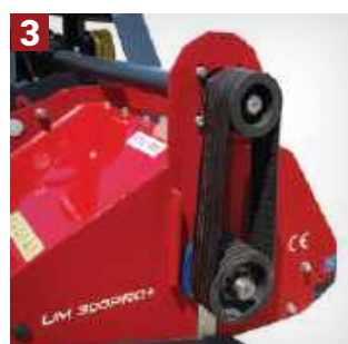
GETRIEBE Über einen speziellen gezahnten Zahnkeilriemensatz mit automatischer Spannung
