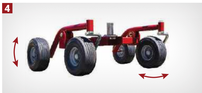
VIERRADOPTION VERTIKALE RADVERSTELLUNG um \pm 10 Grad ermöglicht eine bessere Boden Anpassung, während es der drehbare vordere Radsatz erlaubt, die Fahrtrichtung zu ändern, ohne die Maschine anheben zu müssen
