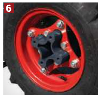
6 ZUSÄTZLICHES RADPAAR montierbar
