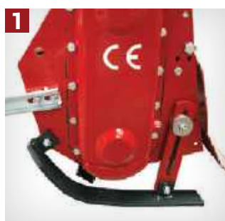
EINSTELLUNG DER FRÄSTIEFE Über seitliche Schieber
