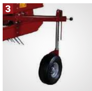
ARBEITSHÖHE- NEINSTELLUNG Erfolgt über Räder
