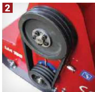
GETRIEBE Über einen speziellen gezahnten Zahnkeilriemensatz
