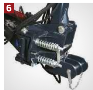
SICHERHEITSEINRICHTUNG Schutzmechanismus mit Fe- dern, ermöglicht die laufende Verschiebung des Mulchers bei einem Aufprall auf ein Hindernis
