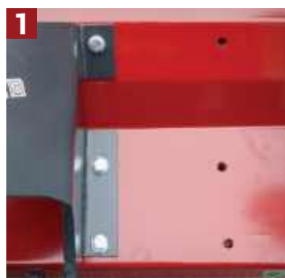
ANSCHLUSSRAHMEN Mit Seitenverstellung in zwei Positionen
